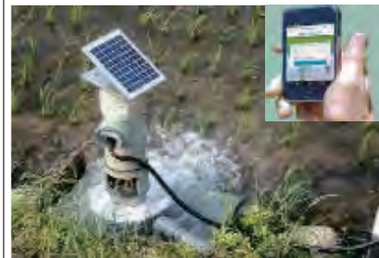
水管理を省力化するための自動給水栓 (広い面積を耕作する担い手や、起伏がある中山間地域の見回り回数削減に有効)
